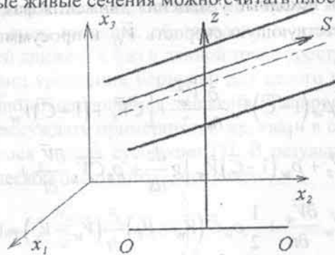
Рис. 1. – К выводу гидравлических уравнений неразрывности и движения
