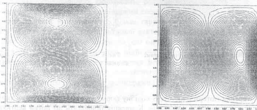
Рис. 1. Розподіли горизонтальної (зліва) та вертикальної (справа) складових вектора швидкості для числа Грасгофа Gr = 1000
