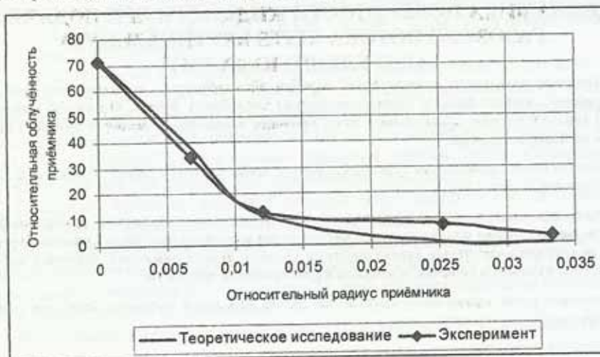
Рис. 6. Сравнение результатов численного исследования с результатами экспериментов
