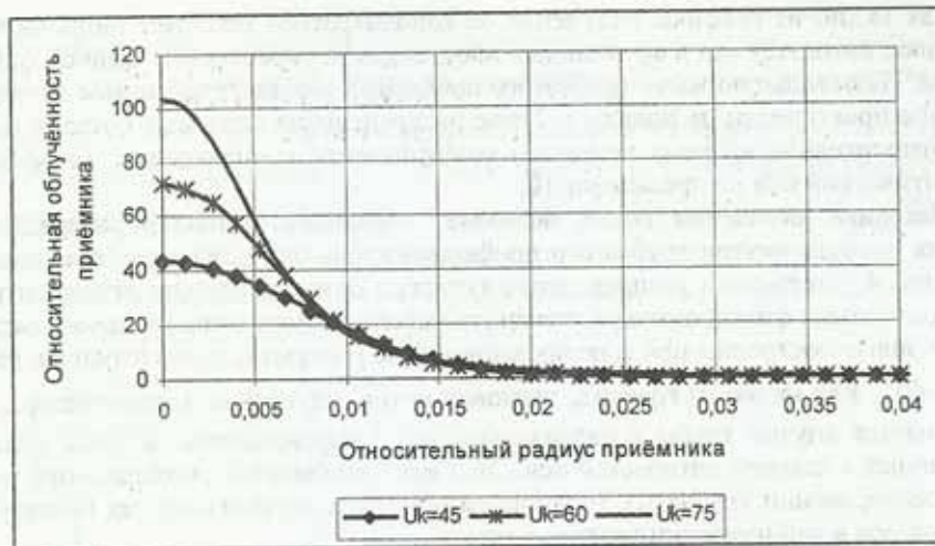
Рис.2. Изменение облучённости линейного приёмника при различных углах раскрытия концентратора
