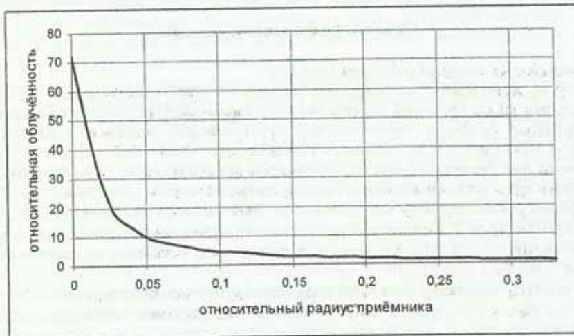
Рис. 5. Тепловые потоки в точках пересечения границы теплоприемника с оптической осью концентратора
