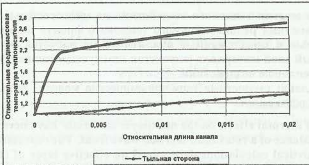
Рис. 3. Изменение среднemasовой температуры теплоносителя по длине канала
