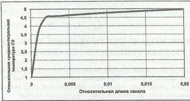
Рис. 2. Изменение среднеинтегральной температуры СЭ по длине канала
