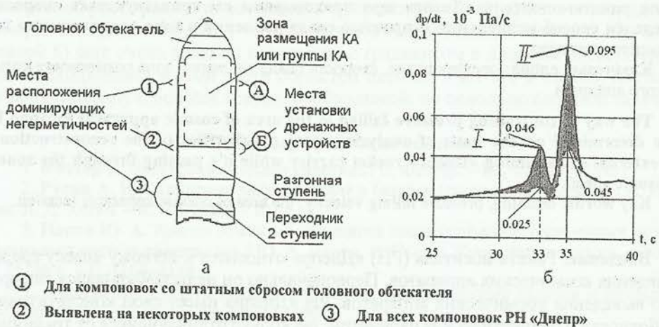
Рис. 1. Некоторые данные и особенности схемы дренирования ракеты-носителя «Днепр»: а) дренируемые объёмы; б) диапазоны изменений скорости спада давления на трансзвуковом участке полёта РН
