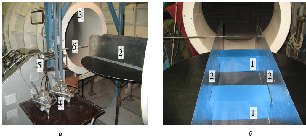
Рис. 7. Экспериментальная установка: 1 – модели зданий; 2 – ограничительные шайбы; 3 – аэродинамическая труба; 4 – микроманометры; 5 – координатник; 6 – трубка Пито
