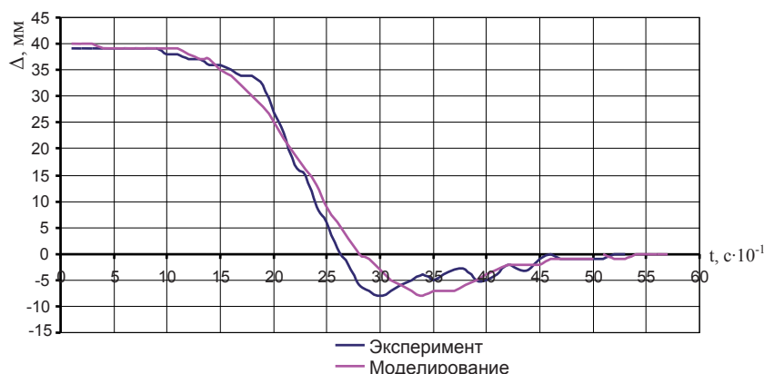
Рис. 4. Переходные процессы реальной и математической моделей робота
