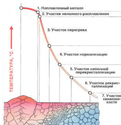
Рис. 3. Термический цикл в сварном шве
