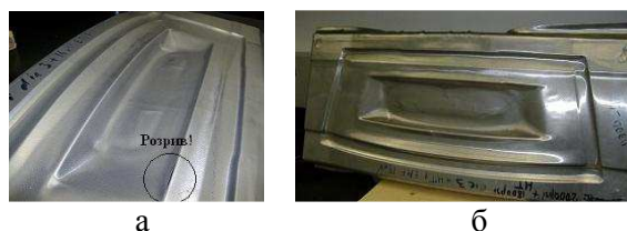
Рис. 3. Задня панель автомобільного кузова моделі «Ford», гострі кути якої відштамповані електрогідравлічною (а), магнітно-імпульсною дією (б)
