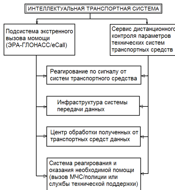
Рис. 3. Схема взаимодействия сервиса дистанционного контроля параметров с системами ЭРА-ГЛОНАСС/eCall
