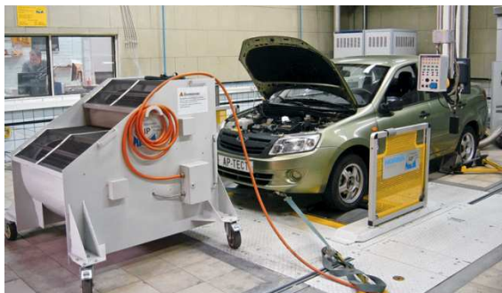
Рис. 3. Стенд з біговими барабанами для випробувань автомобілів на паливну економічність
