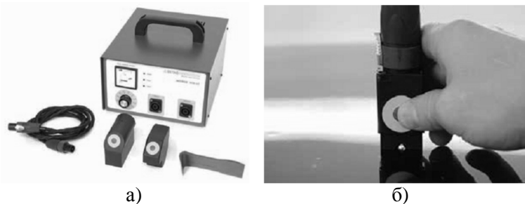
Рис. 3. Устройство «Hotbox» для рихтовки кузовных панелей с помощью локального нагрева: а – внешний вид; б – инструмент в действии
