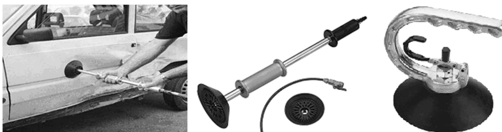
Рис. 4 – Вакуумная рихтовка кузова рихтовочной пневмоприсоской
