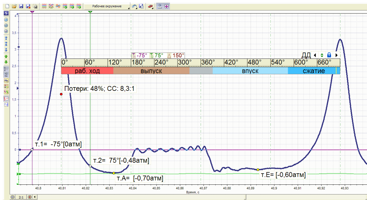
Рис. 2. Осциллограмма давления в цилиндре двигателя с потерями воздуха
