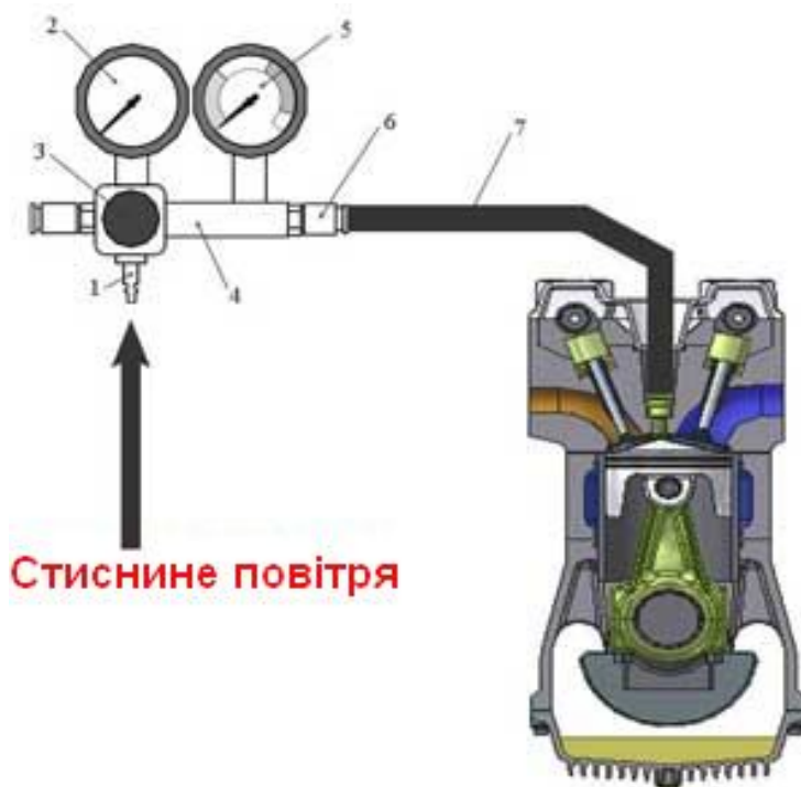
Рис. 1. Схема роботи пневмотестера: 1 - вхідний штуцер, у який подається стиснене повітря із тиском 6-10 Атм; 2 - манометр для виміру тиску підведеного стиснутого повітря; 3 - регулятор тиску підведеного стиснутого повітря; 4 - зворотній клапан; 5 - манометр для виміру тиску в просторі циліндра над поршнем, який дорівнює тиску підведеного стиснутого повітря за мінусом витоків, так само його ще називають манометр контролю втрати повітря; 6 - вихідний штуцер; 7 - шланги та адаптери для підключення до отвору свічі запалювання
