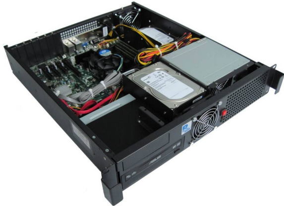
Рис. 6. Сервер R-Line на базі INTEL Xeon E3
