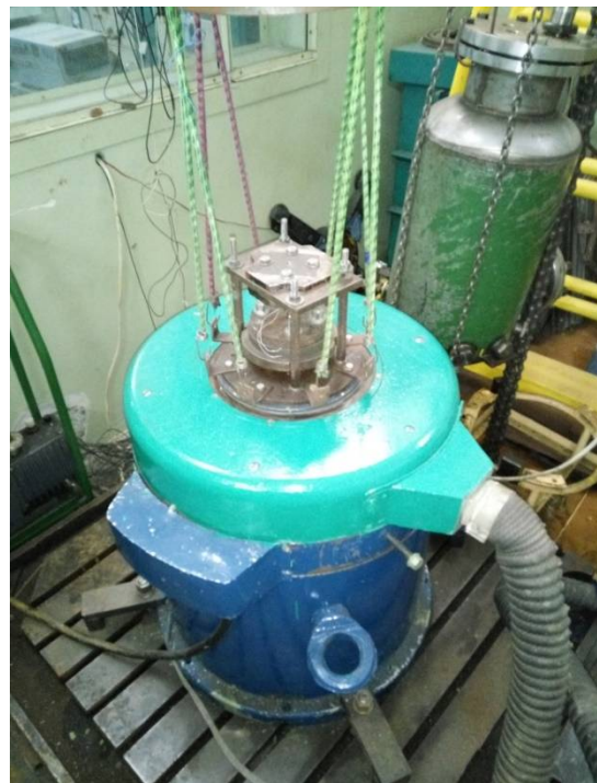
Рис. 2. Випробувальна частина адаптивної підвіски на вібростенді
