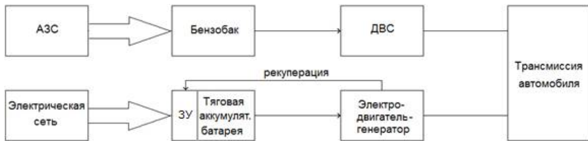
Рис. 1. Функциональная схема подзаряжаемого гибридного автомобиля
