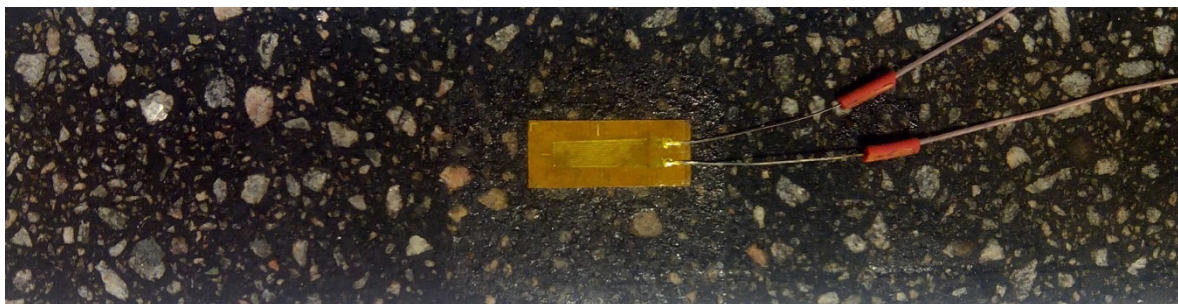
Рис. 4. Балка из асфальтобетона с наклеенным фольговым тензорезистором
