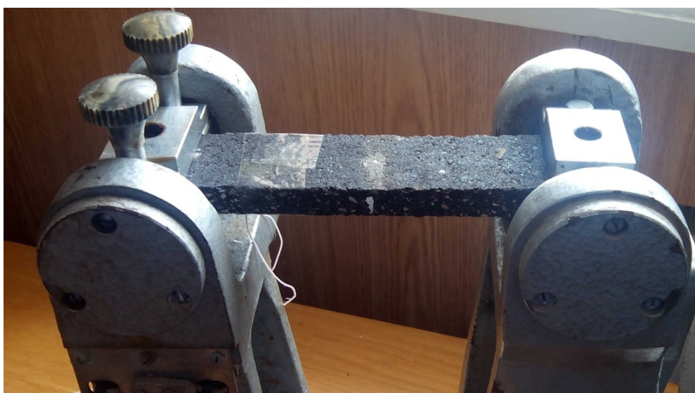
Рис. 3. Шарнирно-опертая балка из асфальтобетона
