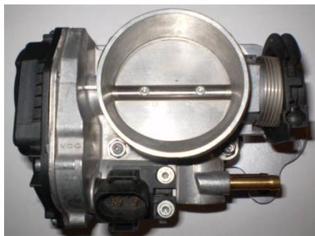
Рис. 8. Дроссельный узел фирмы Siemens с приводом системы холостого хода от шагового электродвигателя с планетарным редуктором и непосредственным приводом поворотной заслонки.
