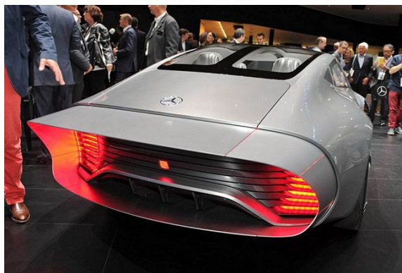
Рис. 2 – Mercedes-Benz Concept IAA у активованому аеродинамічному обвісі
