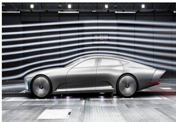
Рис. 3 – Mercedes-Benz Concept IAA у аеродинамічній трубі
