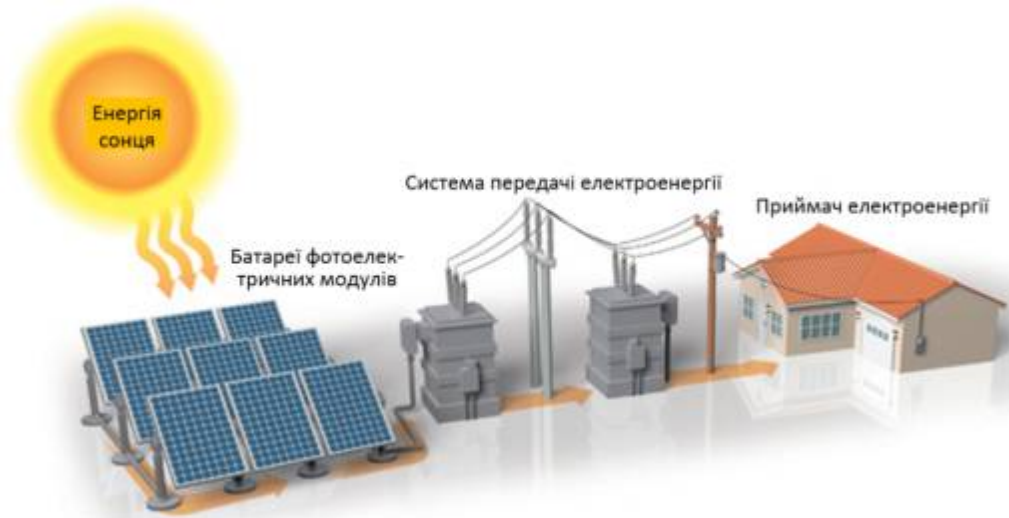
Рис. 6 – Схема СЕС на фотоелектричних модулях
