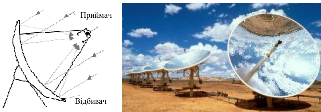
Рис. 5 – Тарілчасті сонячні електростанції
