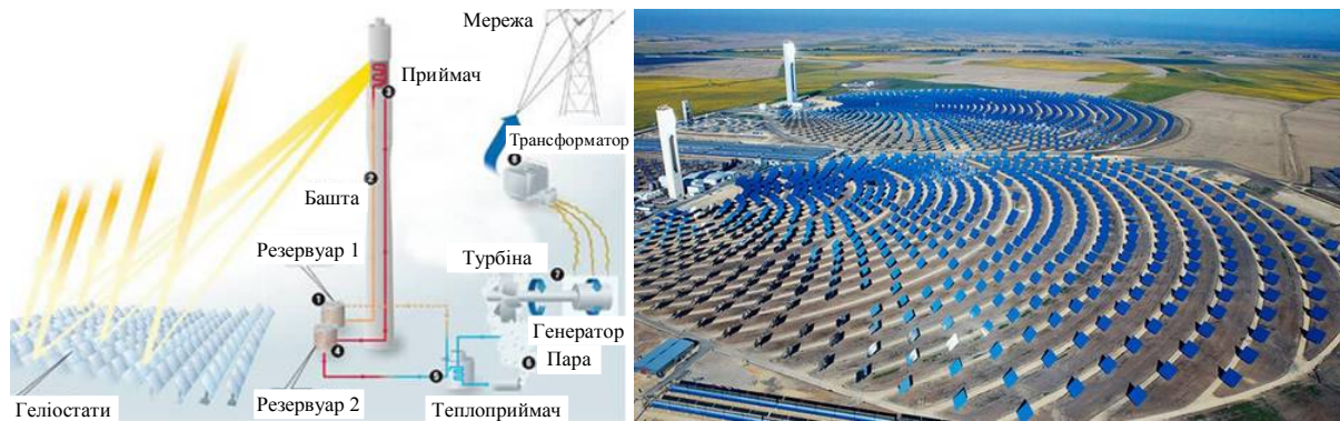
Рис. 4 – Баштові сонячні електростанції
