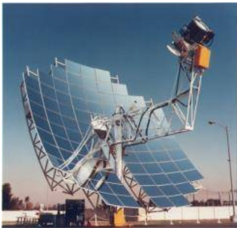
Рис. 13 – СЕС на двигуні Стірлінга
