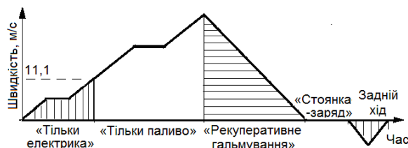
Рис. 1 – Ілюстрація режимів роботи гібридної силової установки автомобіля ЗАЗ Ланос Пікап
