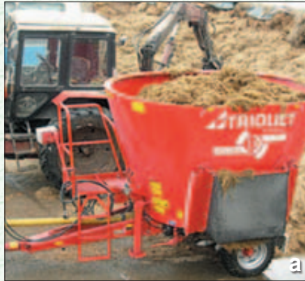
Рис. 5. Кормороздавач фірми «Trioliet» (а) та підбирач кормів (б)
