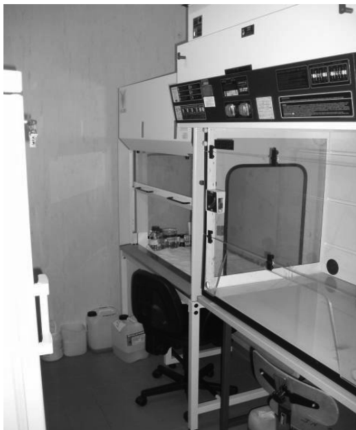
Рис. 1 Бокси біозахисту класу BSL-2
