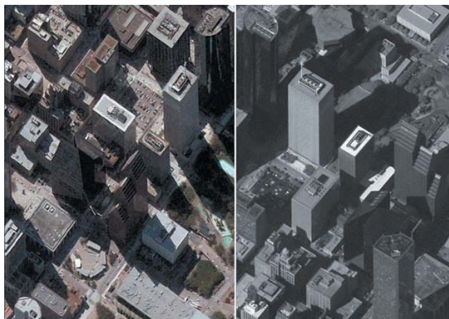
Мал. 1. Мультиспектральний знімок із супутника QuickBird (зліва) та панхроматичний знімок WorldView-1 (справа). Просторова роздільна здатність знімків 61 та 50 см відповідно
