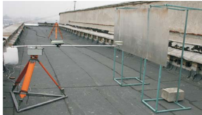
Мал. 2. GPS-приймач на спеціальному пристрої готовий до роботи
