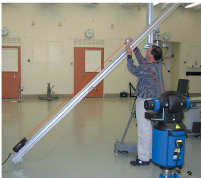
Мал. 8. Процес діагонального тестування сумарного впливу СКП вимірювання горизонтальних і вертикальних кутів
