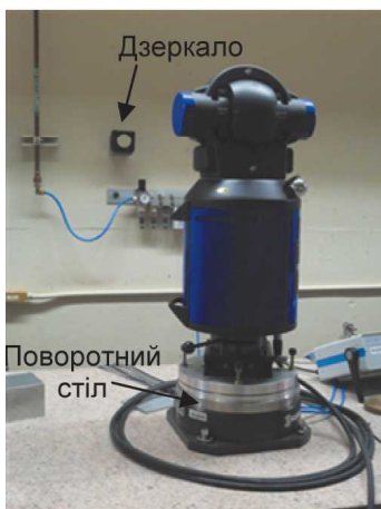
Мал. 12. Загальний вигляд установки для калібрування за допомогою поворотного стола і дзеркала лазерного трекера
