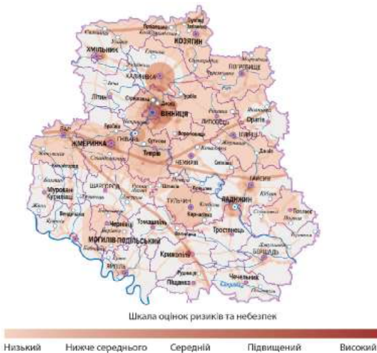
Мал. 5. Інтегральні оцінки техногенної небезпеки по Вінницькій області, виставлені на основі оверлейного аналізу буферних зон потенційно небезпечних об'єктів
