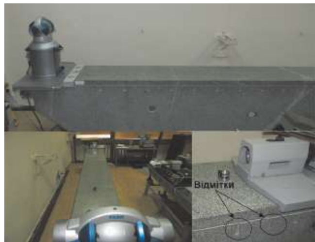
Мал. 4. Дослідження СКП вимірювання вертикальних кутів у нижній частині діапазону вимірювань цим самим трекером
