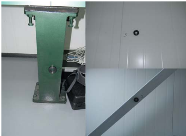
Мал. 2. Звичайні пункти в локальній інженерно-геодезичній мережі
