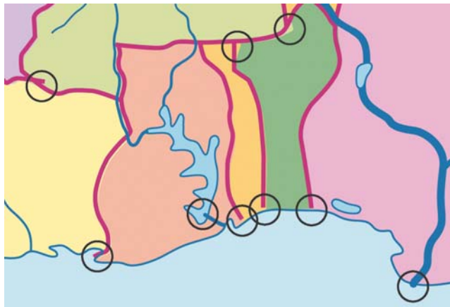
Мал. 1. Векторне зображення з виділеними недоліками укладання географічної основи при збільшенні у 12 разів
