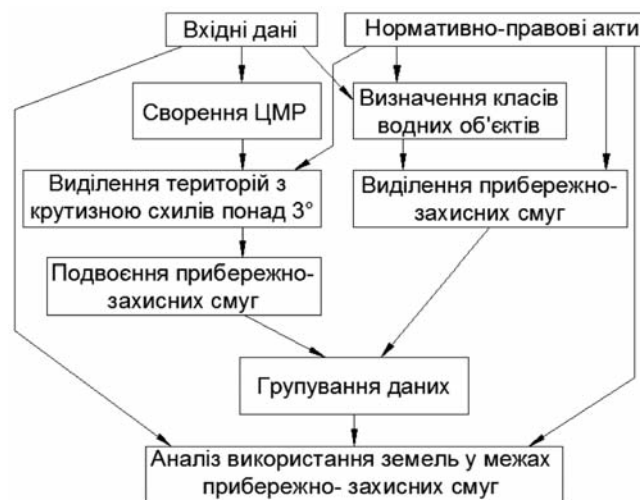
Мал. 11. Функціональна блок-схема для виявлення та аналізу порушень режиму використання земель у межах прибережно-захисної смуги
