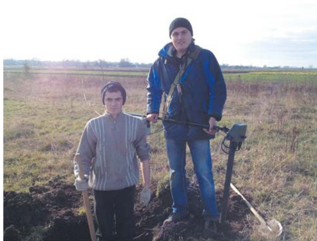
Мал. 1. Виявлення реперів за допомогою металошукача
