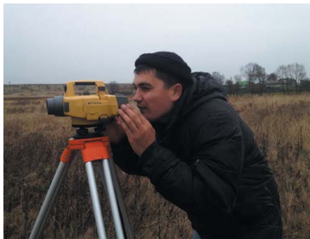
Мал. 2. Вимірювання електронним нівеліром DL-501
