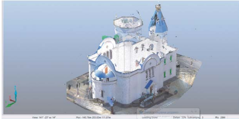
Мал. 1. Тривимірна модель церкви у вигляді хмари точок
