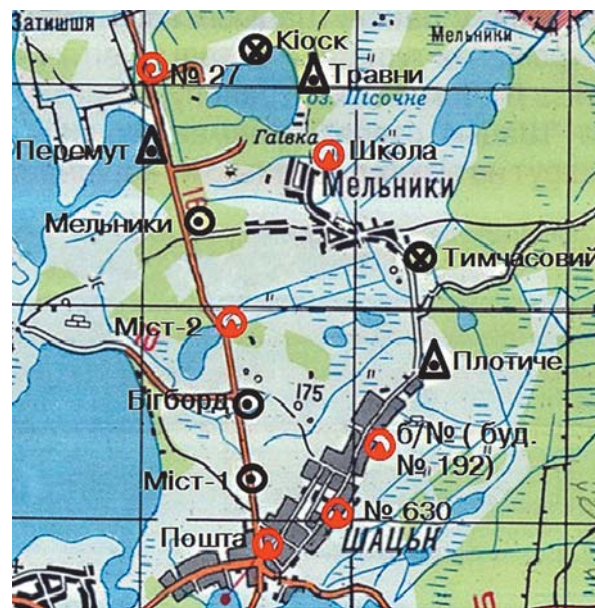
Мал. 1. Схема геодезичного полігона: ● – ґрунтовий репер; ● – стінний репер; ⊗ – закладна точка; ▲ – пункт триангуляції; ⊙ – горизонтальна марка
