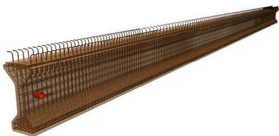
Рис. 2. Модель армування балки 24 м
