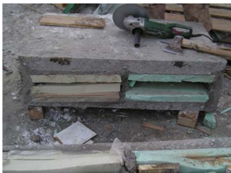
Рис. 1. Изготовление фрагментов колонны и плиты перекрытия на базе строительной фирмы «Вертикаль» (г. Харьков): а – установка для «мокрого» торкретирования; б – укладка бетонной смеси методом торкретирования; в – фрагмент забетонированной колонны и плиты перекрытия; г – разрезка фрагмента плиты перекрытия; д – вкладыш-пустотообразователь внутри плиты перекрытия; е – вкладыш-пустотообразователь внутри четверти колонны
