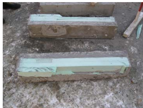
Рис. 1. Изготовление фрагментов колонны и плиты перекрытия на базе строительной фирмы «Вертикаль» (г. Харьков): а – установка для «мокрого» торкретирования; б – укладка бетонной смеси методом торкретирования; в – фрагмент забетонированной колонны и плиты перекрытия; г – разрезка фрагмента плиты перекрытия; д – вкладыш-пустотообразователь внутри плиты перекрытия; е – вкладыш-пустотообразователь внутри четверти колонны
