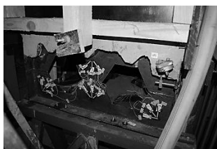
Рис. 5. Тензорезисторы на главных балках, нижнем поясе и диафрагмах
