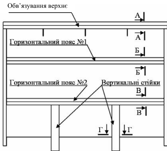
Рис. 2. Варіант виконання стін торцевих універсальних напіввагонів
