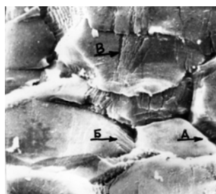
Рис. 3. Структура поверхности образца, \epsilon=124\% , \times 1200
