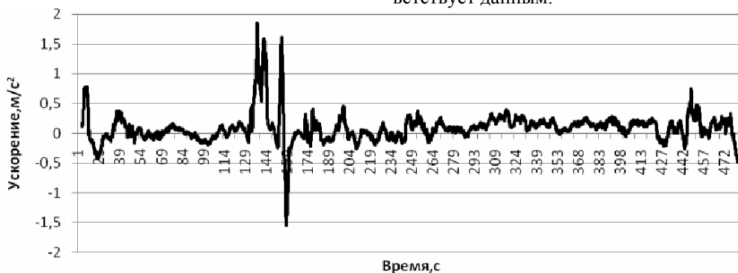
Рис. 4. График продольных ускорений автопоезда с седельным тягачом КрАЗ-6444 при передвижении по предприятию
