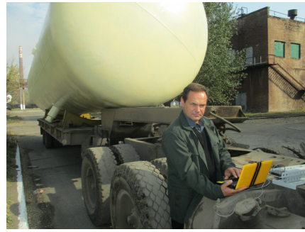
Рис. 3. Установка датчиков ускорений на испытуемом автопоезде с седельным тягачом КрАЗ-6444
