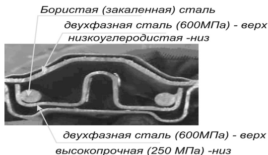
Рис. 2. Использование высокопрочных сталей в конструкции средней стойки автомобиля Subaru WRX
