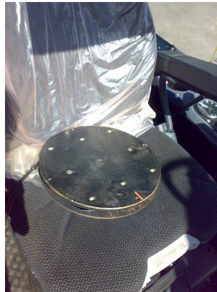
Рис. 6. Установка вибропреобразователя на кресле оператора
