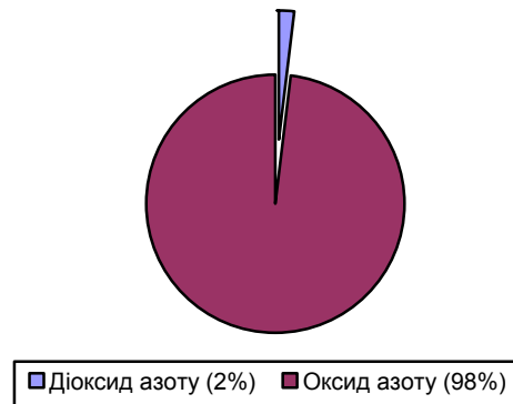
Рис. 3. Розподіл оксиду азоту у ВГ бензинових двигунів
