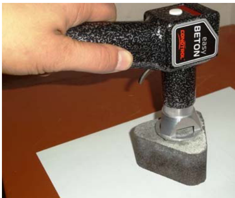
Рис. 5. Эквивалентная мера прочности (бетон)
