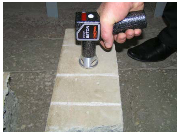
Рис. 6. Определение прочности заторкретированной балки
