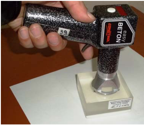
Рис. 4. Эквивалентная мера прочности (стекло)
