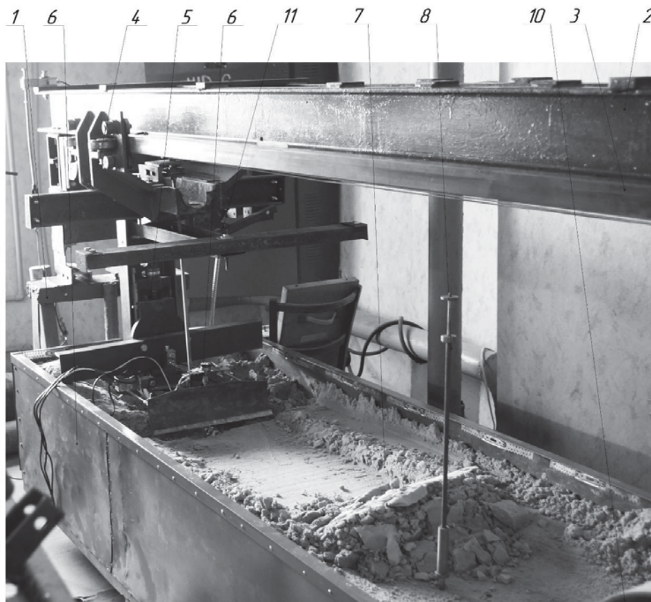
Рис. 1. Общий вид стенда физического моделирования рабочего процесса резания грунта: 1 – жесткая опора; 2 – балка; 3 – направляющие балки; 4 – навесная тележка; 5 – станина; 6 – модель бульдозера; 7 – модель грунта; 8 – ударник ДорНИИ; 9 – контейнер с грунтом; 10 – уплотнительный каток; 11 – привод
