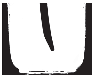
Рис. 8. Отпечаток ножа автогрейдера, подвергнутого закалке ТВЧ, после эксплуатации
