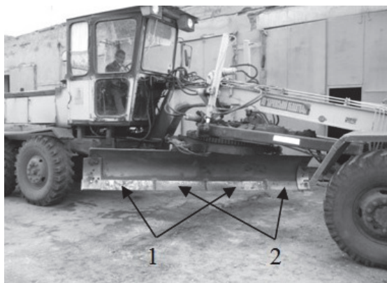
Рис. 4. Общий вид автогрейдера ДЗ-180 с ножами: 1 – после закалки ТВЧ; 2 – после закалки ТВЧ и покрытием \text{TiN-Cr}_2\text{N}
