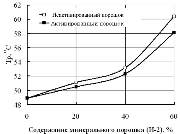
Рис. 1. Влияние активации минерального порошка на его структурирующую способность
