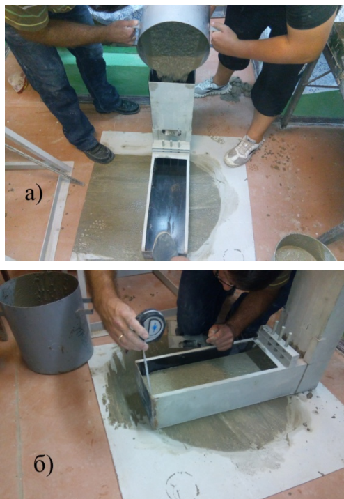
Рис. 13. Проведение испытания для оценки способности самоуплотняющейся бетонной смеси преодолевать препятствия при протекании через труднодоступные узкие места: а – загрузка бетонной смесью L-образного ящика для испытания; б – определение средней глубины бетонной смеси
