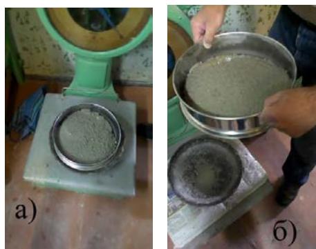
Рис. 14. Проведение испытания свежеприготовленной бетонной смеси на устойчивость к расслаиванию путем просева через сито: а – определение фактической массы бетонной смеси на сите с квадратным отверстием размером 5×5 мм; б – определение массы бетонной смеси, прошедшей через сито
