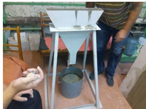
Рис. 12. Проведение испытания самоуплотняющейся бетонной смеси для определения вязкости с помощью V -образной воронки
