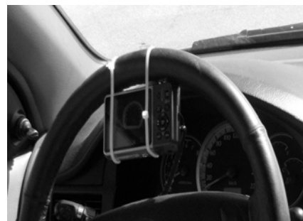
Рис. 1. Закреплённое устройство видеофиксации на рулевом колесе
